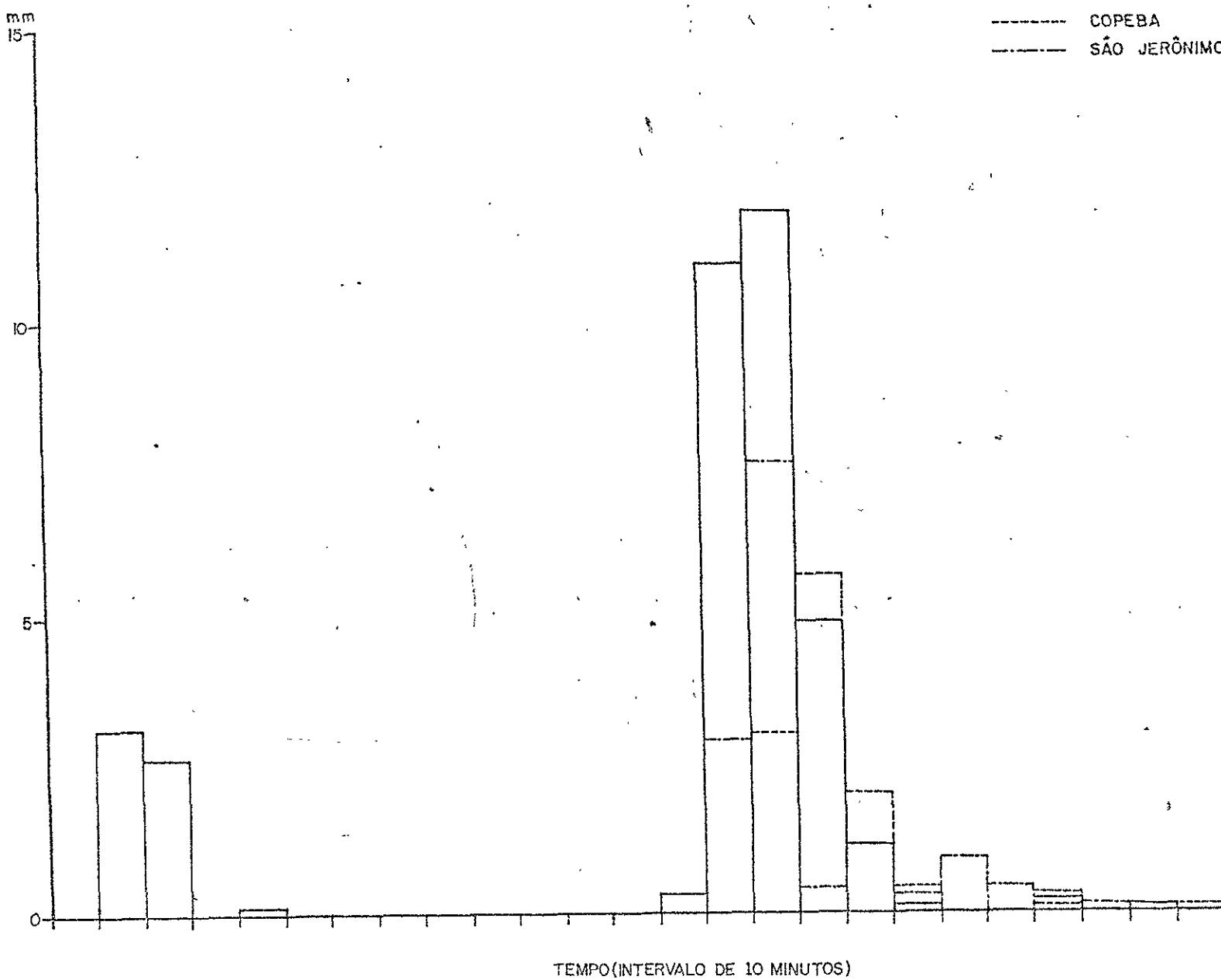
lume de excesso de chuva com o volume de água efetivamente escoado na seção de jusante. Para isto foi necessário efetuar um processo de tentativa e erro que permitisse determinar os parâmetros de infiltração. O processo foi encerrado quando se atingiu os seguintes valores:
