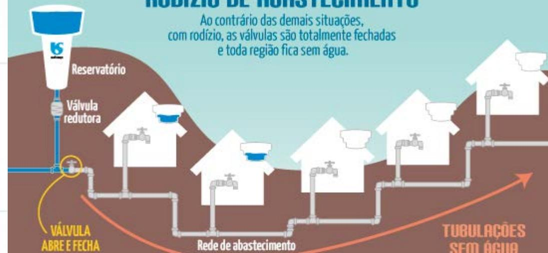
COM A DESPRESSURIZAÇÃO DAS REDES POR LONGO PERÍODO, EXISTE O RISCO DE CONTAMINAÇÃO PELA ENTRADA DE ÁGUA DO SOLO ATRAVÉS DE FISSURAS NA TUBULAÇÃO.
