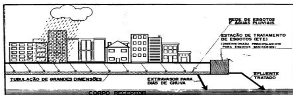
Figura 3 - Desenho esquemático do sistema Tempo Seco
